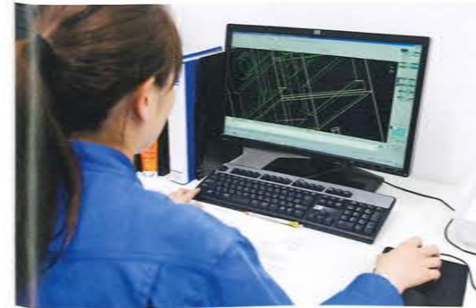
CAD/CAMからの加工指示情報から加工プログラムを作成。事前に位置確認などを行う。
